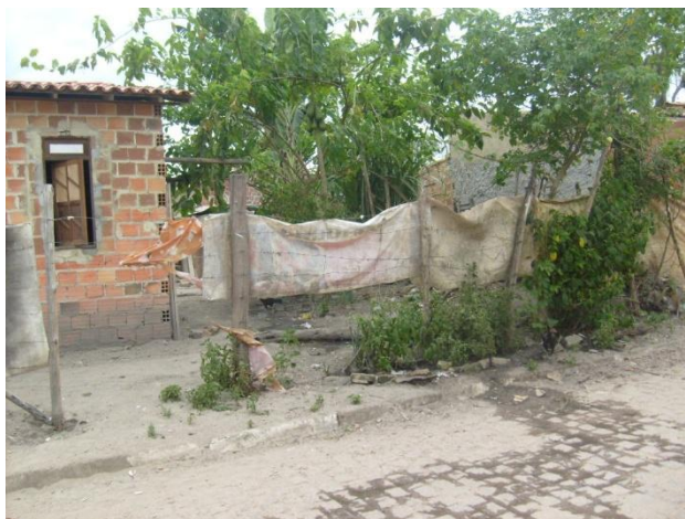
Figura 29 - Bacia 9- Loteamento Santa Terezinha com efluentes doméstico de águas cinzas lançado a céu aberto- PAC1
