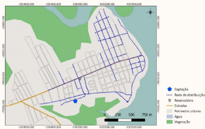
Figura 1 – Sistema de abastecimento de água em Marudá, concentrado nos bairros de “turismo de segunda residência”. Fonte: Teixeira (2015)
